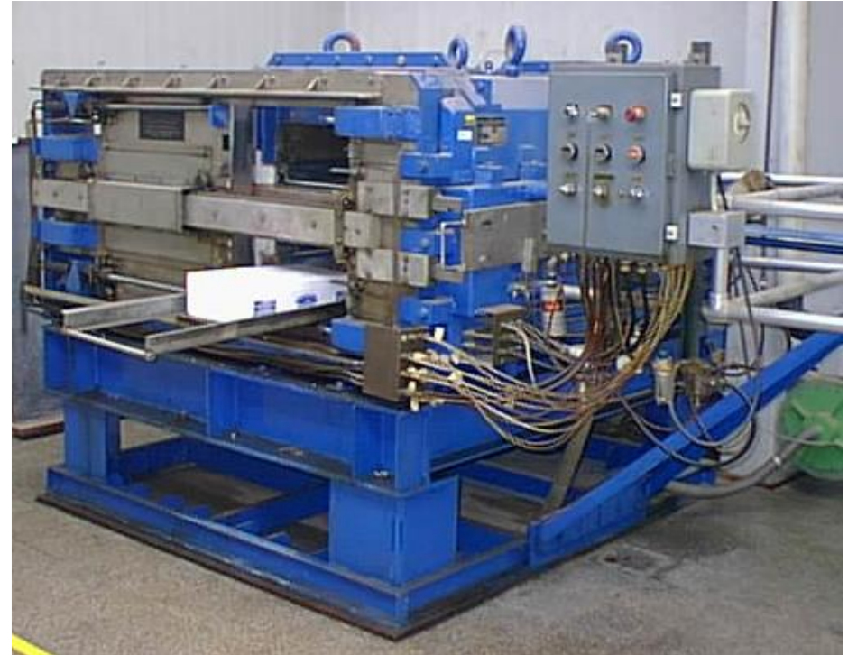
Irradiador experimental - ^{137}\text{Cs} carga 7 L x 2 Actividad 30000 Ci
