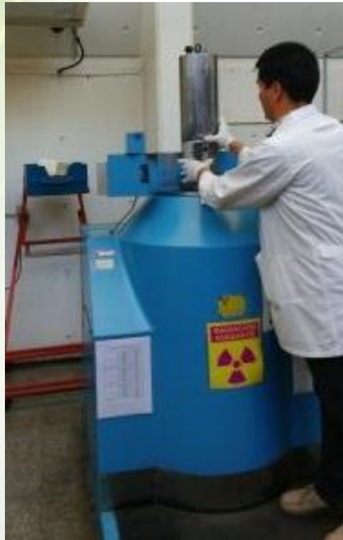
Irradiador experimental - ^{60}\text{Co} carga 2 L Actividad 800 Ci
